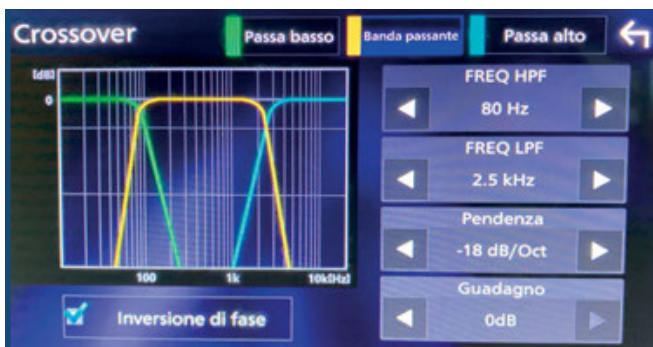
È possibile impostare il DSP di bordo per un sistema a due vie (front/rear e sub) o tre vie (woofer, tweeter e sub, in foto).
