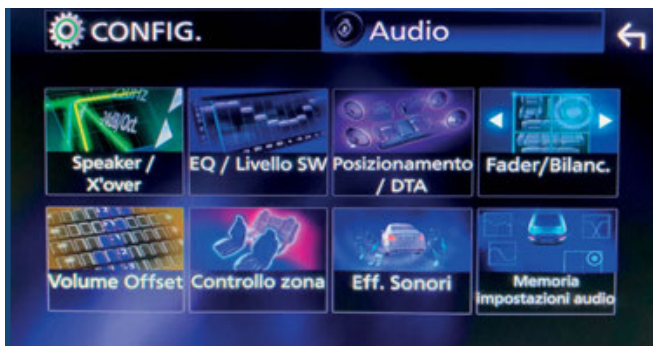
Il menù delle funzionalità audio. Quasi tutte queste funzioni sono gestite dal DSP interno.
